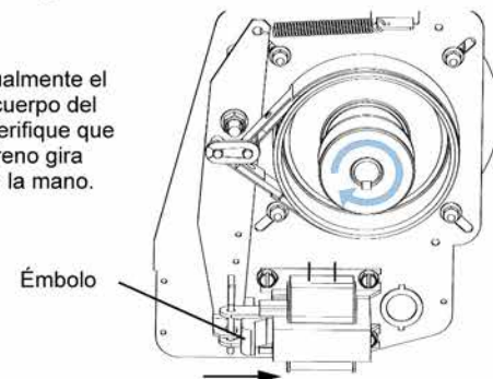
Figura 49 - Procedimiento de ajuste de la banda de freno
