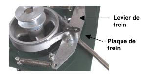
5. Maintenez les goupilles levées à l'aide d'un tournevis pour remplacer l'attache rapide (entre la plaque de frein et le levier de frein); ceci stabilisera les goupilles en leur position initiale pour pouvoir replacer l'attache rapide.
